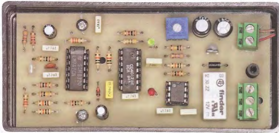
Fig.13 In questa foto potete vedere il circuito dello stadio ricevente montato ed inserito all'interno del mobile plastico che abbiamo appositamente predisposto.
