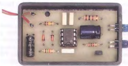
Fig.10 Foto del TX montato e collocato all'interno del relativo mobile plastico.
