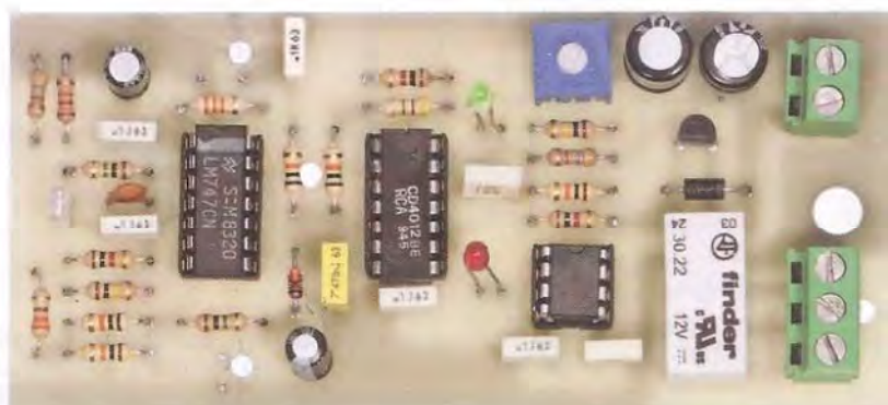
Fig.12 Foto del circuito dello stadio ricevente come si presenta a montaggio ultimato.
