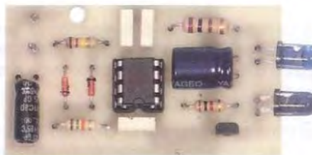
Fig.9 Foto dello stadio trasmettitore a montaggio concluso.
