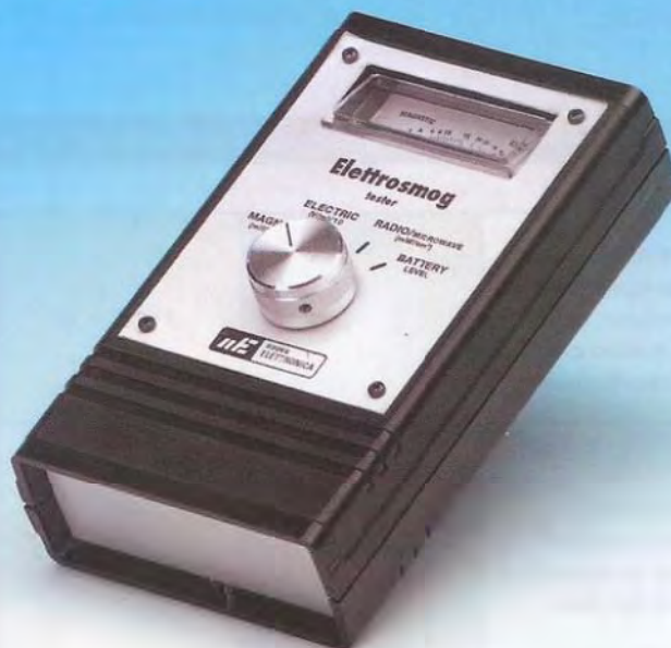
Fig.1 Nella foto è riprodotto il nostro rivelatore di elettrosmog che consente di eseguire 3 diverse misure, vale a dire quella dei campi elettrici in bassa frequenza, dei campi magnetici in bassa frequenza e dei campi elettromagnetici in radiofrequenza.
